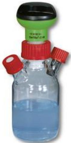
El uso de frascos de medición especiales con válvulas de conexión laterales y cierre de tapón permite la adición sin perturbación de substratos y soluciones.
